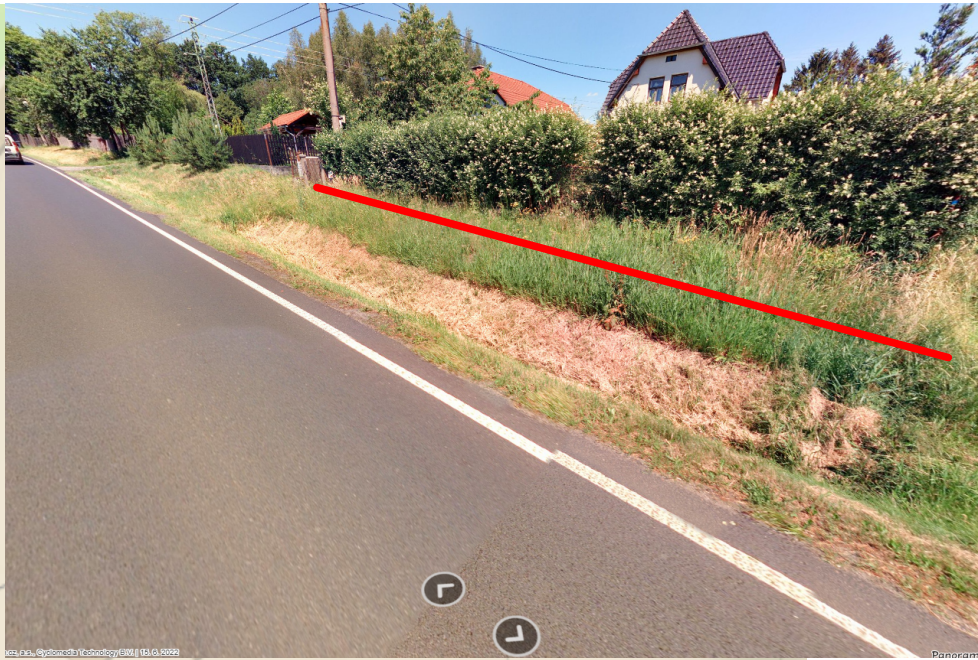
Podélný výkop v nezpevněné části pozemku cca 15m.
